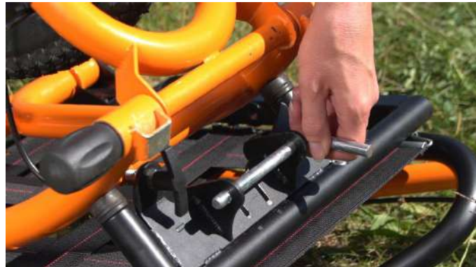
4- Enlever la goupille de sécurité et retirer l'axe de son logement
