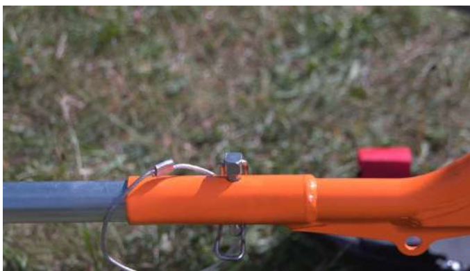
17- Verrouiller les bras avec la goupille de sécurité
