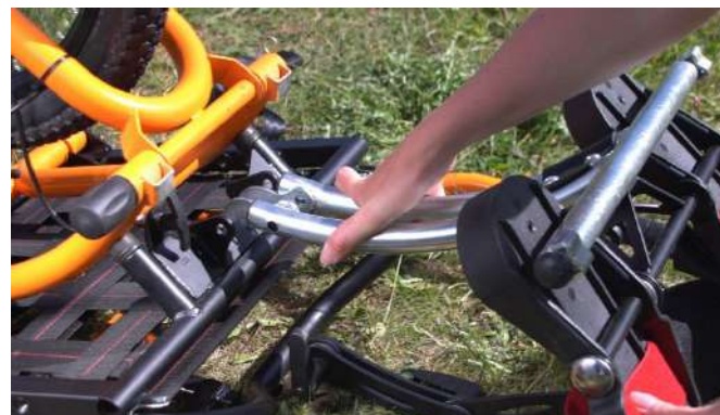
6- Positionner le pied dans les encoches tout en serrant les deux tubes afin de faciliter son insertion
