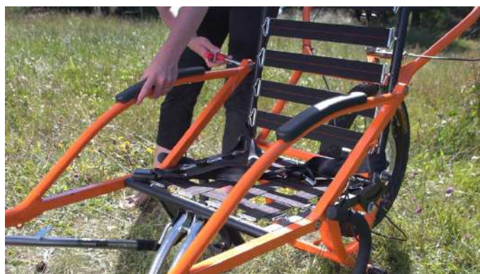
12- Procéder de même pour l'assise et serrer les deux vis. Répéter l'opération sur le second bras. Vérifier que les deux bras soient vissés correctement.
