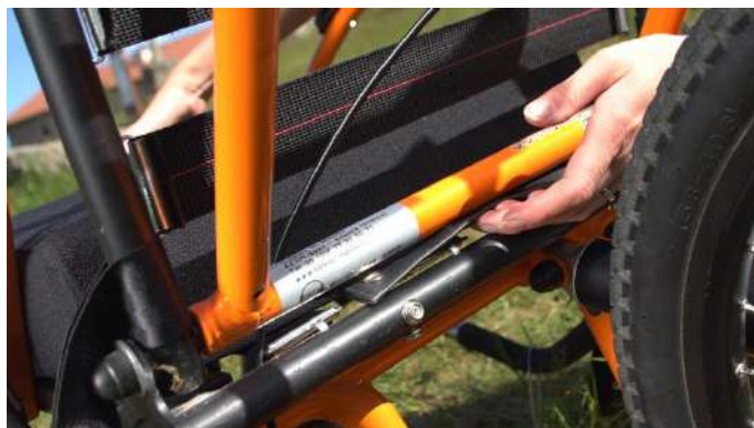
14- Faire passer le système d'accroche sous le dossier et appuyer sur les pressions. Vérifier que les boutons pressions soient bien attachés.
