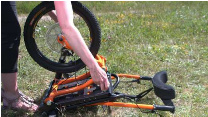
3- Repositionner la broche dans son axe et remettre la goupille
