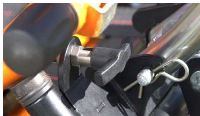
8- Positionner le doigt d'indexage à l'horizontale
