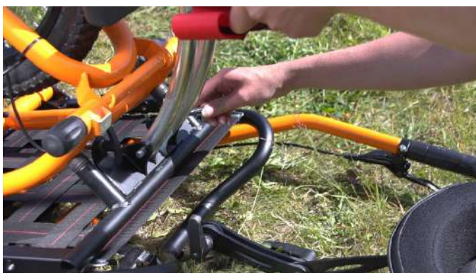
7- Remettre l'axe dans son logement et le bloquer vers l'intérieur. Puis remettre la goupille de sécurité
