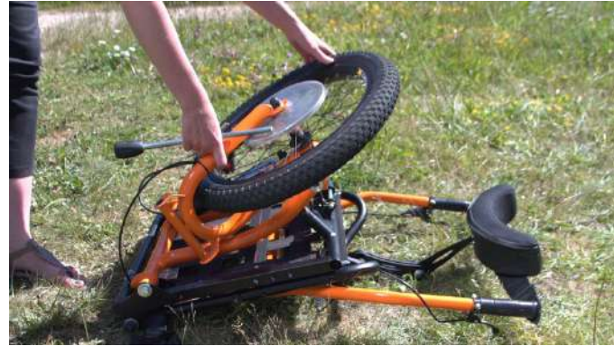
2- Retirer la broche et la goupille de leur emplacement et faire pivoter la roue
