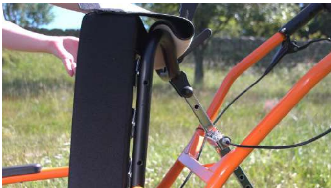
15- Positionner le coussin du dossier en passant la doublure en tissu derrière le dossier et le maintenir à l'aide du scratch.
